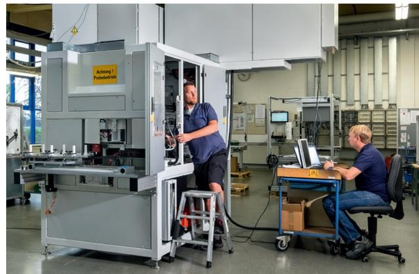
Inbetriebnahme einer Sondermaschine
