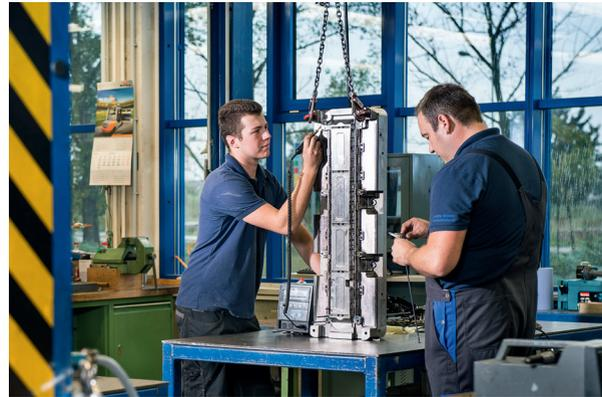
Montage eines Spritzgusswerkzeuges
